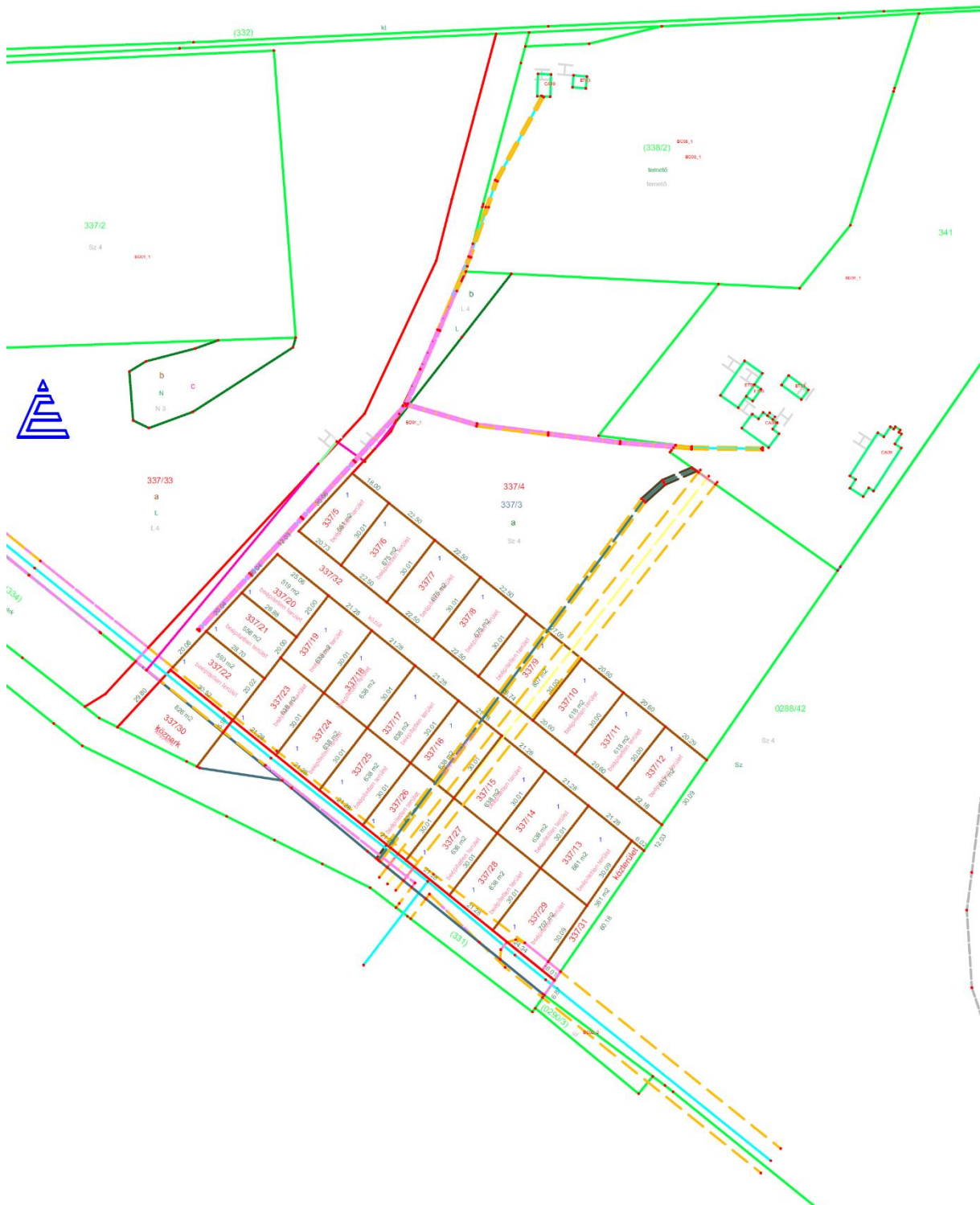
4. ábra: A lakóterület kialakításához készített geodéziai felmérés és változási vázrajz (forrás: Geo Mega Alfa Kft.)
